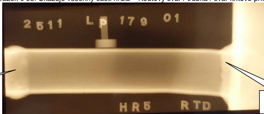
Obrázek č 03. Ukazuje všechny části hrdla – Koutový svár / trubka / svár krkové příruby.
